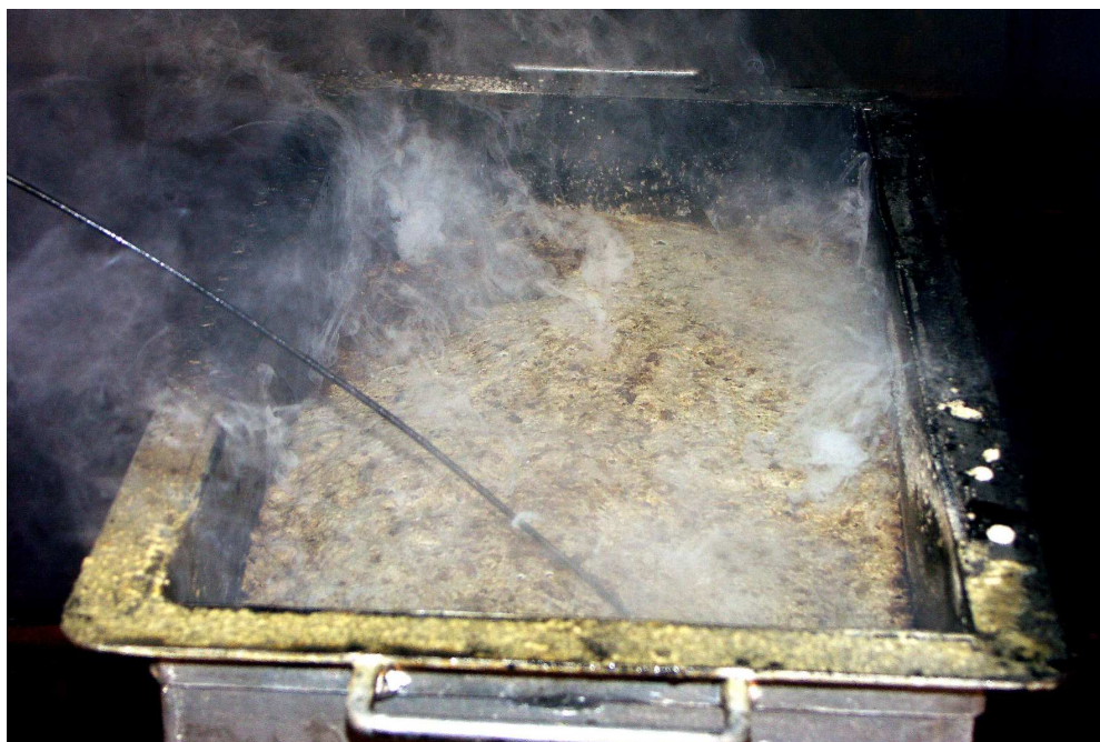
Obr. č. 8 Pohled na zmydelnatělou krustu po použití hasiva Neufrol M – „meterin“
