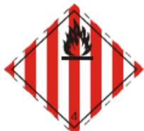
Hořlavé tuhé látky, samovolně se rozkládající látky a zncitlivěné tuhé výbušné látky
